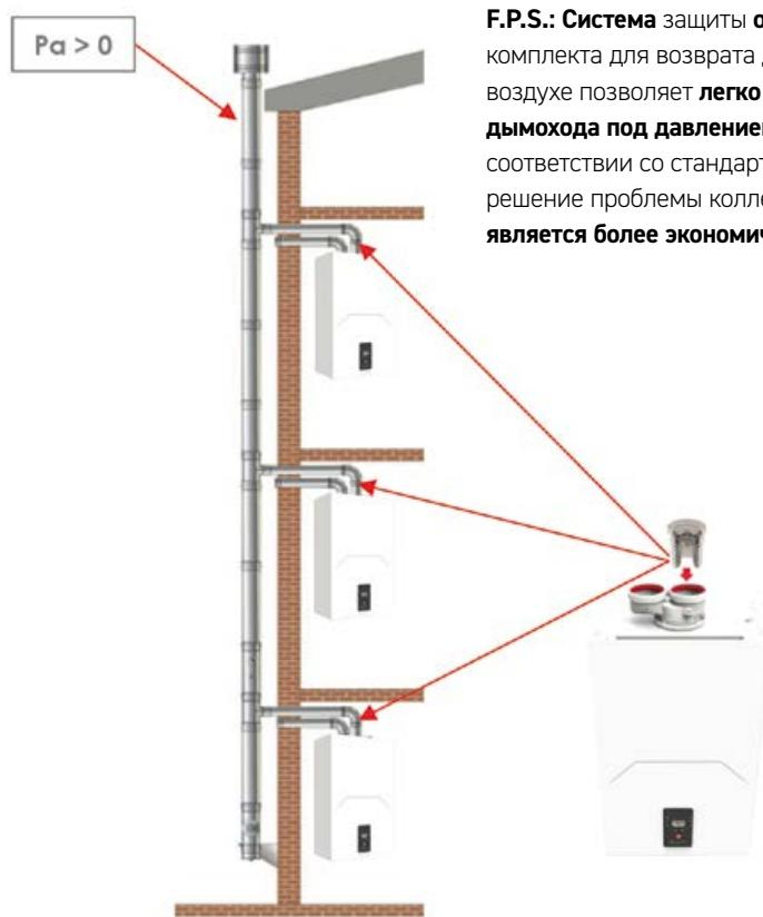
**F.P.S.: Система защиты от дымовых газов.** Установка специального комплекта для возврата дымовых газов (опционально) на открытом воздухе позволяет **легко подключаться к системам коллективного дымохода под давлением** (например, при реструктуризации) в соответствии со стандартом UNI 7129. Для других монтажников **решение проблемы коллективного дымового газа под давлением является более экономичным** (уменьшение диаметра дымовых труб).
