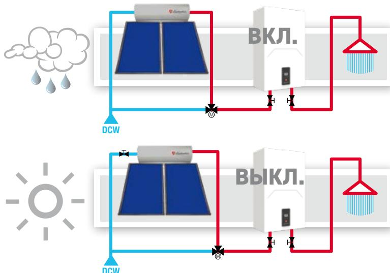
В случае недостаточного облучения и, следовательно, умеренного предварительного нагрева горячей воды, котел будет выделять необходимое количество тепла для достижения требуемой заданной температуры.
