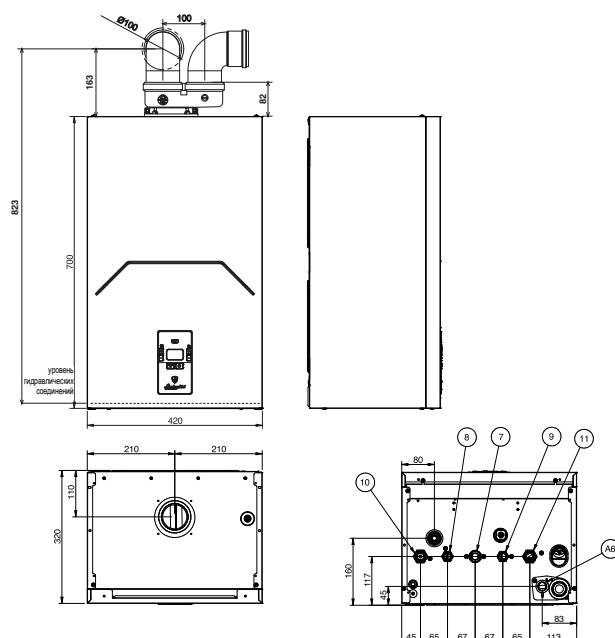
**КНОПКИ - 7** Вход газа 3/4 дюйма **8** Выход ГВС 1/2 дюйма **9** Вход ГВС 1/2 дюйма **10** Подающая линия 3/4 дюйма **11** Обратная линия 3/4 дюйма
